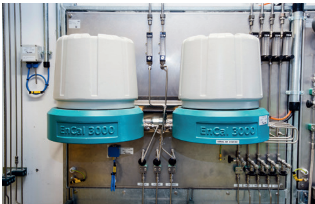
Abb. 3: 14-Komponenten-Prozessgaschromatograf, aufgebaut als Vierströmer für die Gasanalyse und die eichrechtliche Brennwertermittlung der einzelnen Abrechnungsgebiete
